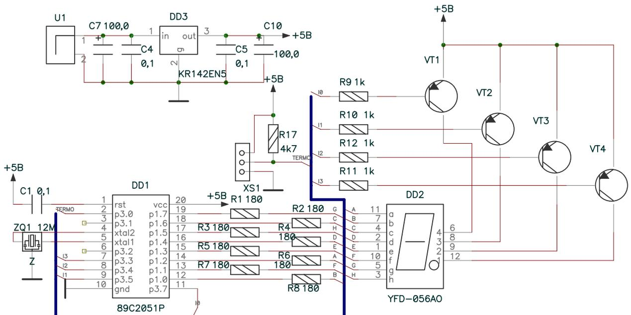
При включении питания происходит чтение регистра режима работы датчика и, если необходимо, режим перепрограммируется на требуемый. Опрос датчика осуществляется в циклическом режиме (из датчика считывается температура, значения регистра счетчика и регистра калибровки). Динамическое обновление индикатора осуществляется с частотой 100Гц на каждую цифру. После сборки прибор работает сразу без настройки.
